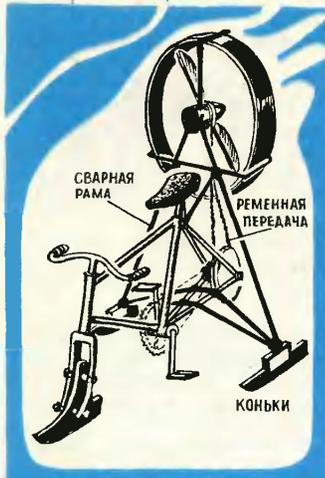
**АЭРОВЕЛОСИПЕД.** Миша Колотуша из села Ревутицы Сумской области предложил интересный спортивный снаряд. Его основа — велосипедная рама. Вместо колес — три конька. Сзади — воздушный винт диаметром 600—800 мм. Передаточное отношение от педалей к винту около 10. Винт и шкив задней звездочки связаны ременной передачей.
